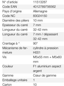
ePoignée de fenêtre **SecuSignal**® HOPPE – poignée de fenêtre en aluminium, verrouillable à clé avec **Secu100**®+ **Secustik**® et **VarioFit**® pour fenêtre à ouverture oscillo-battante :
