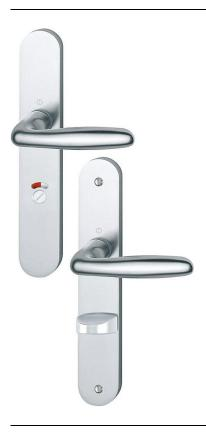
N° d'article 758104 Code EAN 4012789387445 Pays d'origine Allemagne Code NC 83024110 Epaisseur de porte 40 mm Epaisseur du carré 7 mm Epaisseur du carré 6 mm pour WC Longueur du carré Percement voyant rougeblanc/olive de condamnation Entraxe de perce-70 mm ment Vis vis métaux Couleur F1 aluminium aspect argent Gamme Cœur de gamme Emballage unitaire Carton 16
